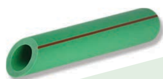
ท่อน้ำร้อน Class: SDR6 PN20 อุณหภูมิใช้งาน 3 - 95 องศา แรงดันสูงสุด 20 BAR
